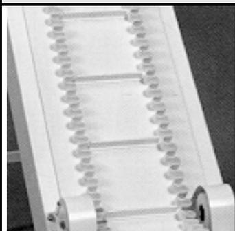
Toutes les bandes P.V.C. et PU peuvent être équipées de différents profils longitudinaux ou transversaux.
